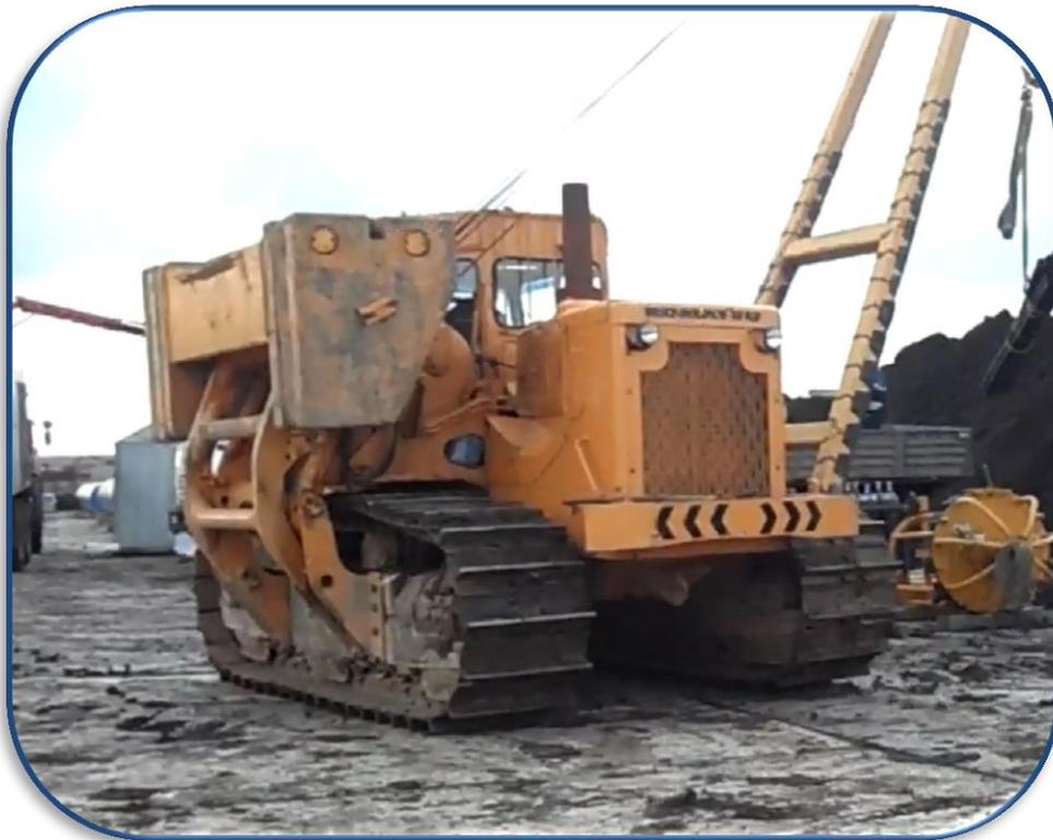
В процессе движения трубоукладчиков при протаскивании трубопровода боковое скольжение техники не зафиксировано.
